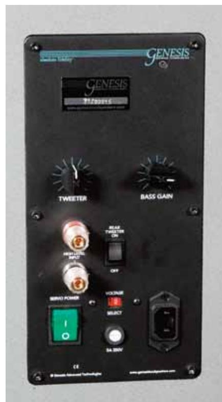
Il pannello posteriore dove si può osservare il tweeter posto in alto, mentre in basso vi sono le regolazioni del crossover e del livello dell'amplificatore in classe "D" del subwoofer, assieme ai post WBT per il collegamento all'ampli o finale che sia.
